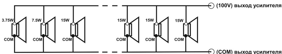
После того, как Вы подключили акустическую систему к спикерной линии нужно установить CRW4T в заранее подготовленное отверстие в потолке. Для этого необходимо поместить корпус в отверстие таким образом, чтобы верхние крепежные лепестки оказались за потолком, а нижние с внешней стороны потолка. После этого аккуратно поочередно (правую-левую стороны) углубляйте корпус акустической системы в монтажное отверстие до тех пор пока лицевая панель корпуса не упрется в потолок.
